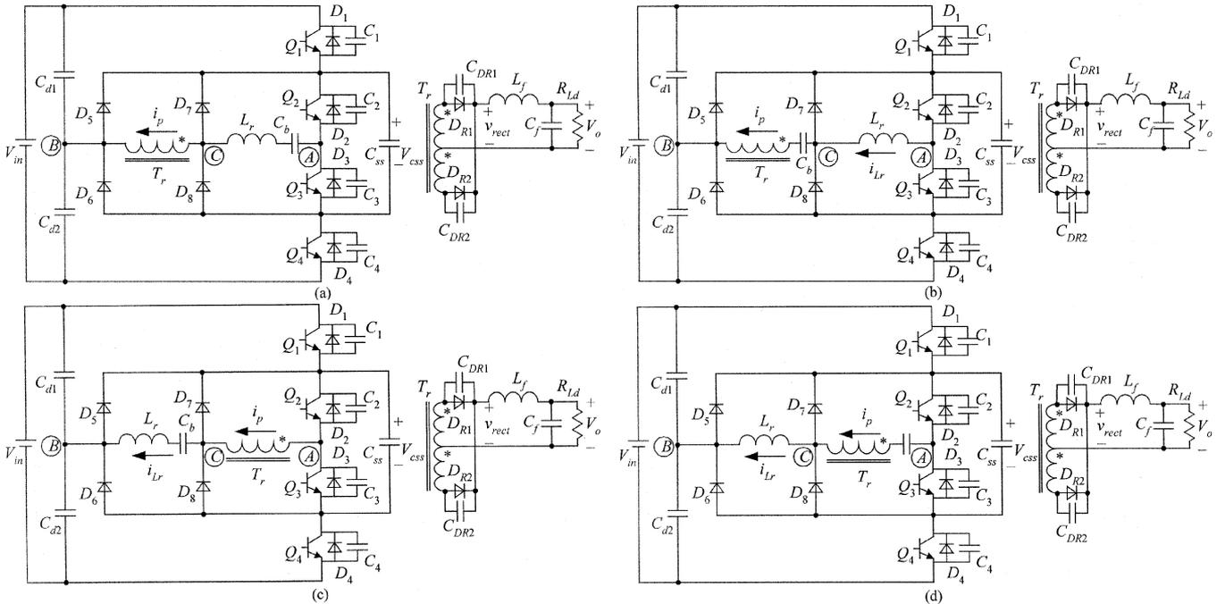
Fig. 7. Four topologies. (a)  $T_r$ -lead-LC Type. (b)  $T_r$ -lead-TC Type. (c)  $T_r$ -lag-LC Type. (d)  $T_r$ -lag-TC Type.
