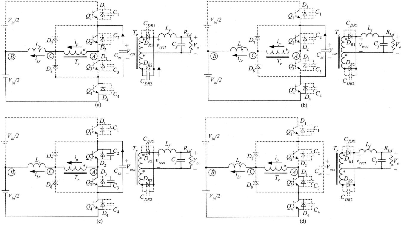
Fig. 6. Equivalent circuits of four switching modes of the simplified converter. (a)  $[t_1, t_2]$ . (b)  $[t_2, t_3]$ . (c)  $[t_3, t_4]$ . (d)  $[t_4, t_5]$ .
