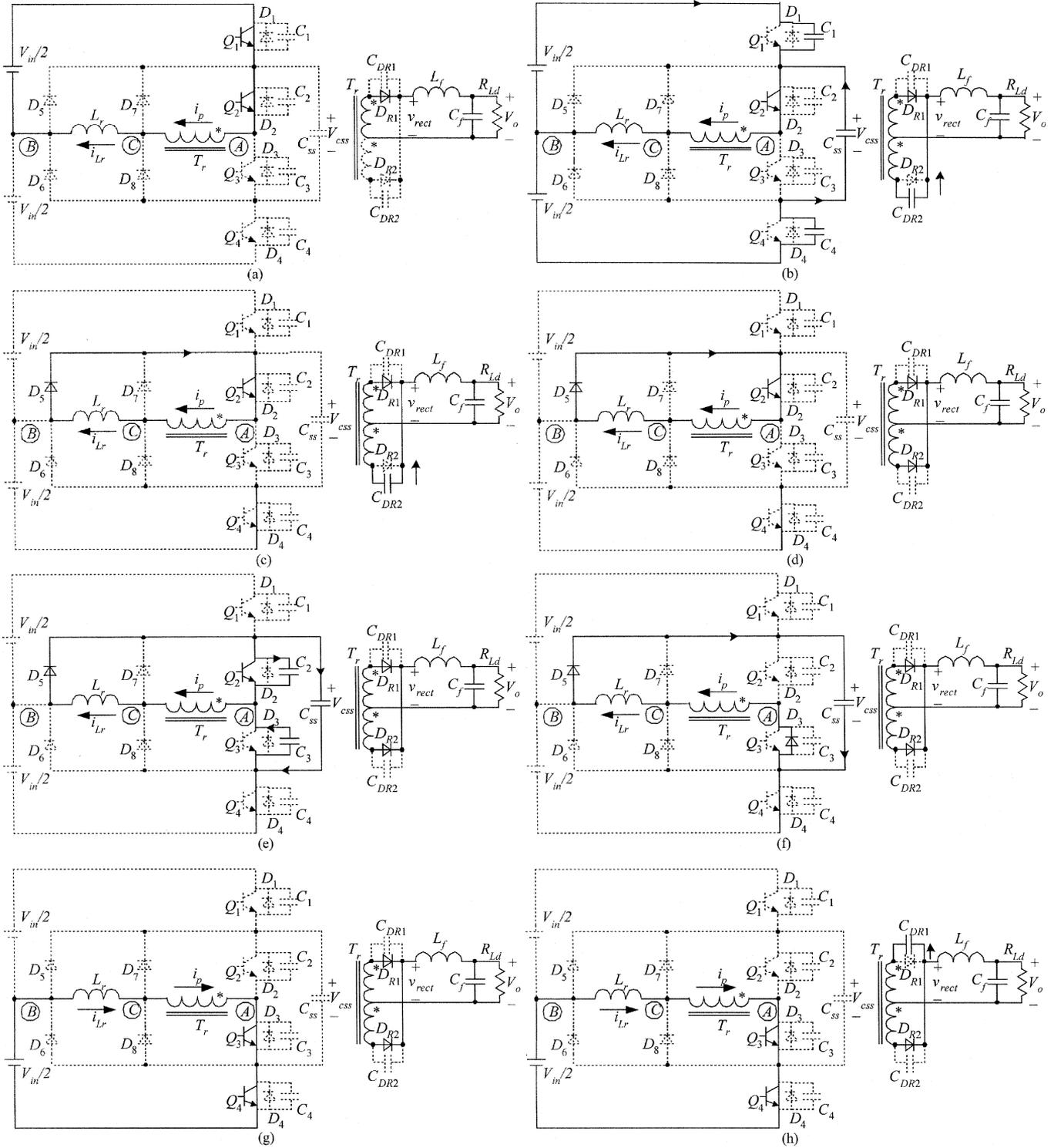
Fig. 3. The equivalent circuits of each switching mode. (a) Prior To  $t_0$ . (b)  $[t_0, t_1]$ . (c)  $[t_1, t_2]$ . (d)  $[t_2, t_3]$ . (e)  $[t_3, t_4]$ . (f)  $[t_4, t_5]$ . (g)  $[t_5, t_6]$ . (h)  $[t_6, t_7]$ .
