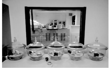
图 1 实验用真空干燥皿及温湿度记录仪
